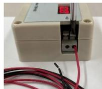
電圧計の右側の端子にケーブルを装着する。
