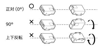
設置角度がずれている場合、通信距離が短 くなり通信できない事があります
